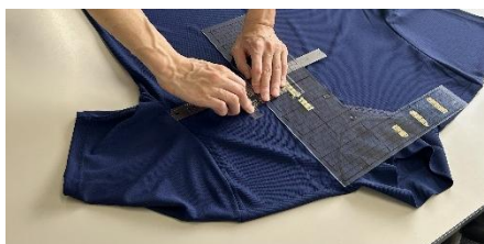
治具を使用した位置合わせ作業
